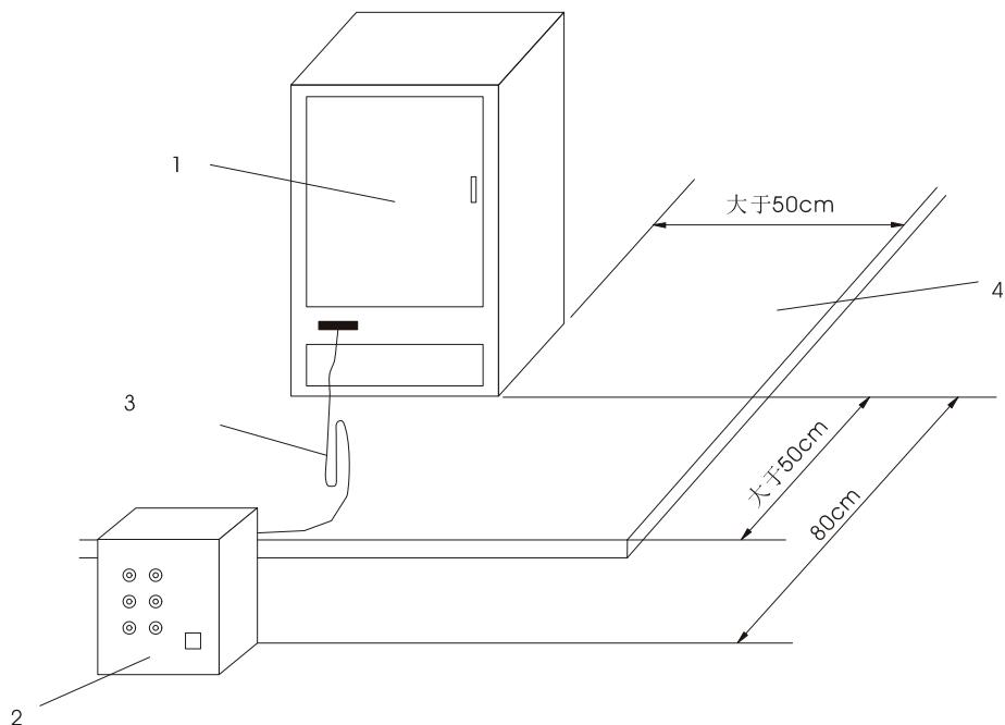
图 8 落地式设备的布置方法
