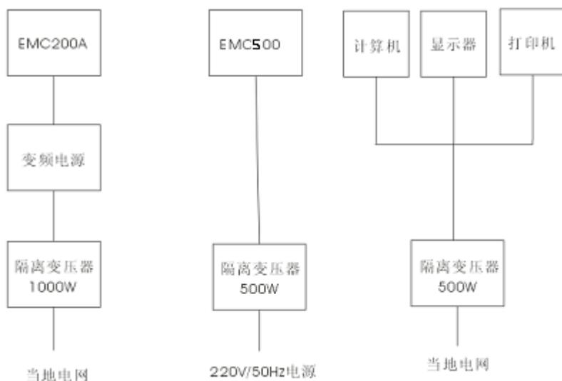
图 3 隔离变压器的摆放
