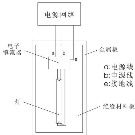
图 4 电子镇流器测量布置方法
