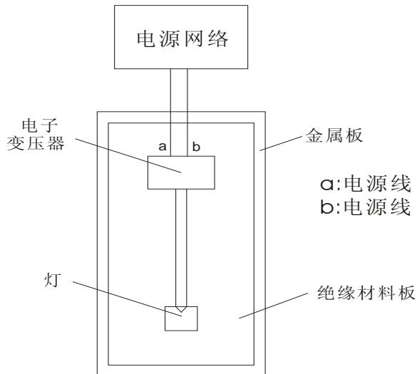
图 5 电子变压器测量布置方法
